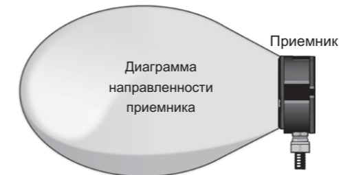
Вид сбоку, иллюстрирующий соответствующие рабочие диапазоны датчика и приемника при использовании их в качестве единой системы.
